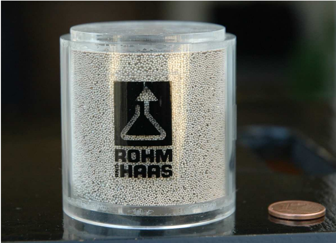
Abb. 4: Muster eines makroporösen Austauschers
